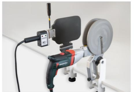
**Elektrischer Planhobel und elektr. geregeltes Heizelement**
